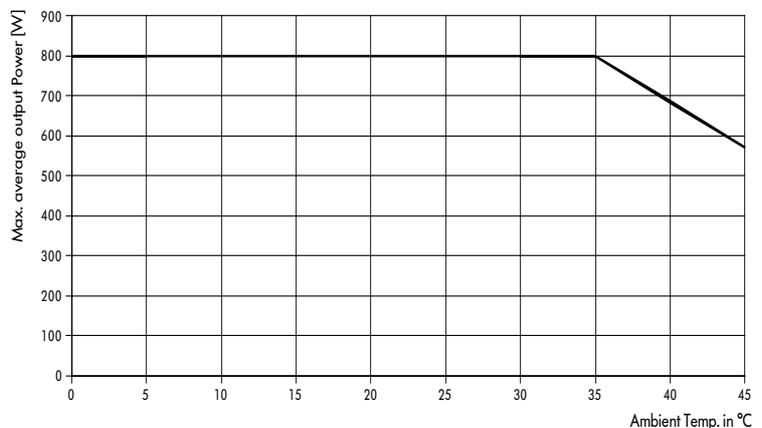
**Fig. 22: Summe der maximalen, mittleren Ausgangsleistung in Abhängigkeit der Umgebungstemperatur**
