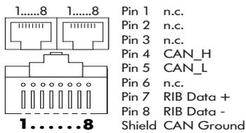
**Fig. 10: Pinbelegung RJ45-Remoteanschluss**
