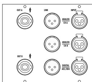
Fig. 28: D12 Anschlussplatte NL4
